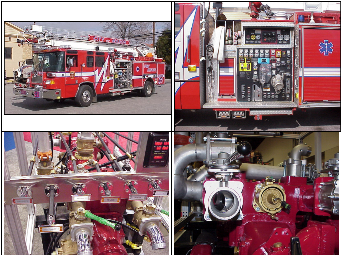
Abb. 8: Pumpenstand US-amerikanischer Feuerwehrfahrzeuge
