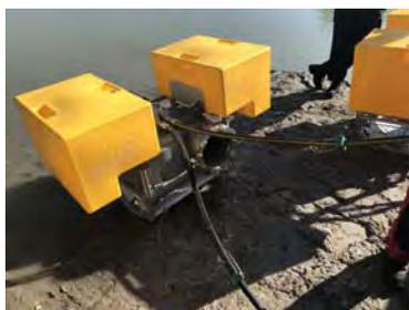
Der Freistaat Bayern hat zudem zusätzlich zum Abrollbehälter HydroSub ein Flut-Modul bestehend aus drei Pumpen in der Stadt Passau stationiert. Das Modul ist speziell für Hochwassereinsätze hinter Deichen oder mobilen Wänden gedacht und entspricht rechnerisch dem Einsatz von rund 40 Tragkraftspritzen. Mit dieser Zusatzausstattung kann
